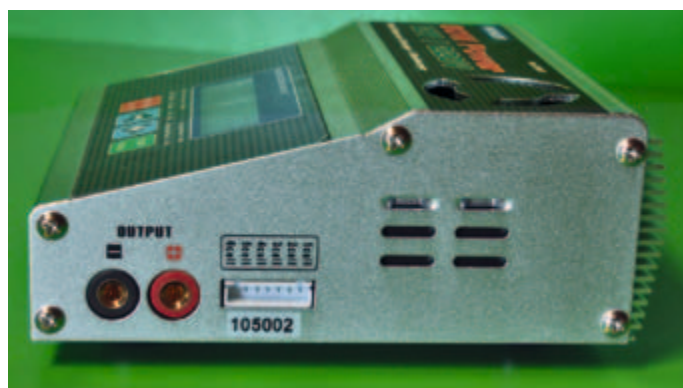
Ein Balancer für bis zu sechs Zellen ist integriert. Für den Anschluss liegen drei Adapter bei.
