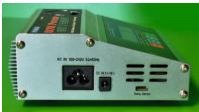
Dank eingebautem Netzteil kann das P60 entweder am heimischen Stromnetz oder an einer Gleichstromquelle angeschlossen werden.
