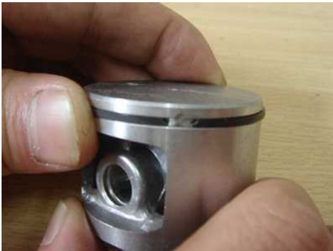
5. Kolbenbolzen-Sicherungsring Erforderliche Teile: Sicherungsring 40060 x 1 Spitzzange erforderlich
