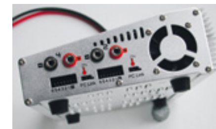
Ladebuchsen und Schnittstellen je zur Hälfte rechts und links angeordnet. Die Ventilatoren sind leistungsgesteuert und von angenehmer akustischer Zurückhaltung
