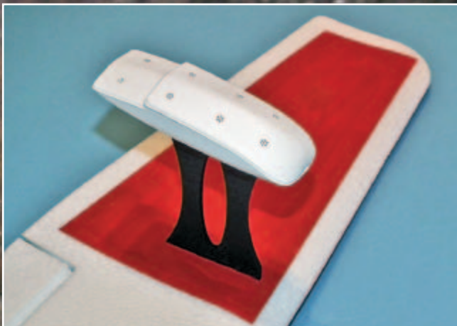
Diese Stützwimmer sucht man beim Vorbild vergebens. Sie sind aber beim Modell nötig, wenn Sie in Verdrängerfahrt mit Seitenwind zum rettenden Ufer schippern.
