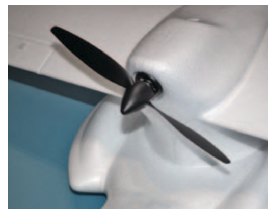
Der Motor des Druckantriebs ist fertig eingebaut und durch die Kapselung nicht mehr zugänglich, ohne zum Messer zu greifen. Er liefert aber ausreichend Leistung.
