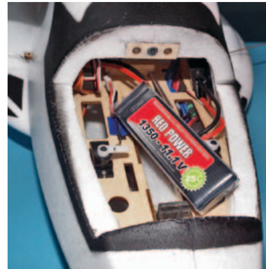
Der 1.350er Akku, den Pichler für das Modell empfiehlt, passt zwar perfekt in die Akkuanne, ist aber wegen der Schwerpunktlage 70 g zu leicht.
