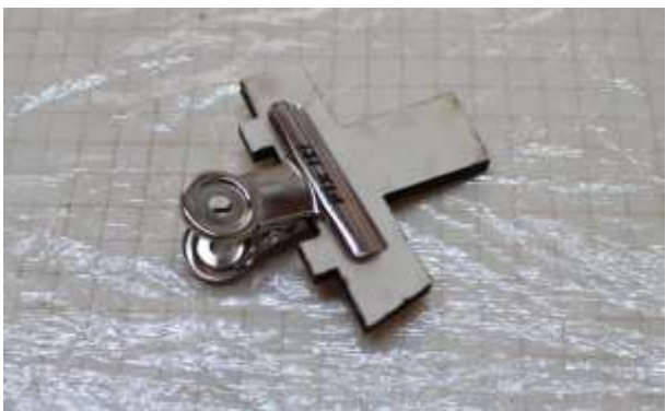
Leitwerkshalter aus (2x E20) verleimen.
