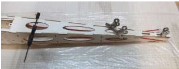
Obere Rumpfbeplankung (G1) verleimen
