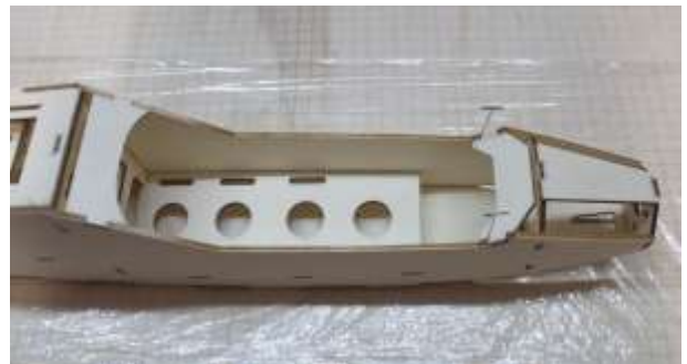
Halbspanten (E5 und E6) im Kabinenhaubenausschnitt und oberes Beplankungsteil für Rumpfspitze (E7) einleimen.
