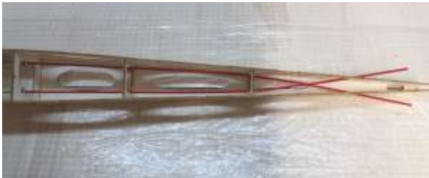
Bowdenzüge für Seiten- und Höhenruder in den Rumpfspanten einfädeln und in den Spanten verkleben. Auf Leichtgängigkeit achten.
