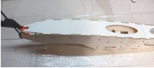
Vordere, untere Rumpfbeplankung (G3) verleimen.
