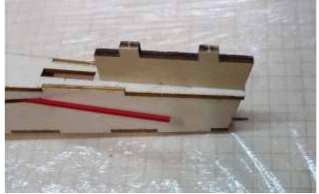
Leitwerkshalter (E20) am Rumpf einleimen. Darauf achten, dass dieser vollflächig auf der Rumpfbeplankung (G1) aufliegt und in die Ausnehmung in der unteren Rumpfbeplankung (G2) einrastet.
