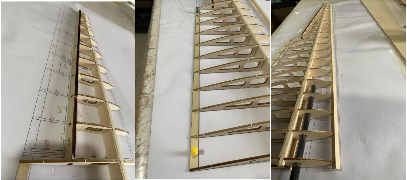
62-63: Obere und untere Flächenbeplankung aufkleben.
