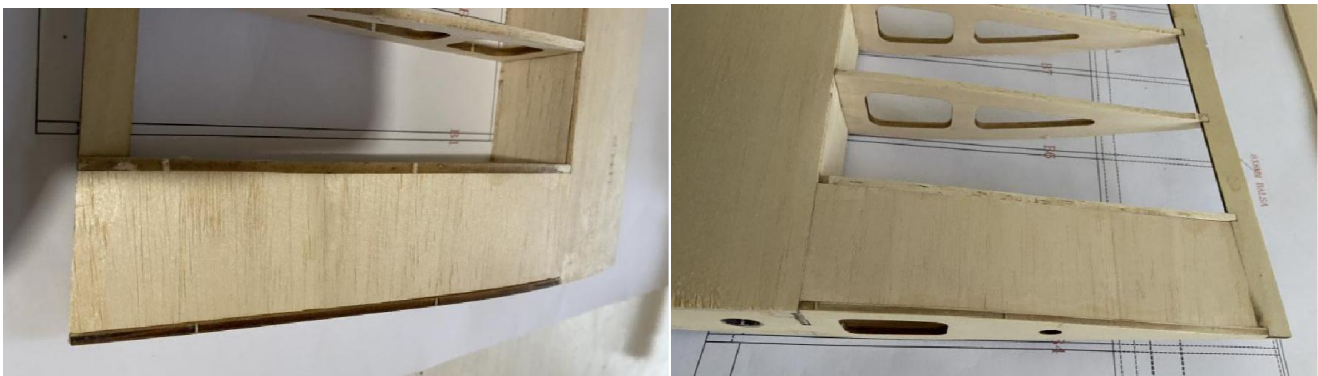
64-65: 2 mm Balsa zur Abdeckung verwenden.
