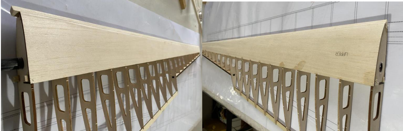
64-65: 2 mm Balsa zur Abdeckung verwenden.
