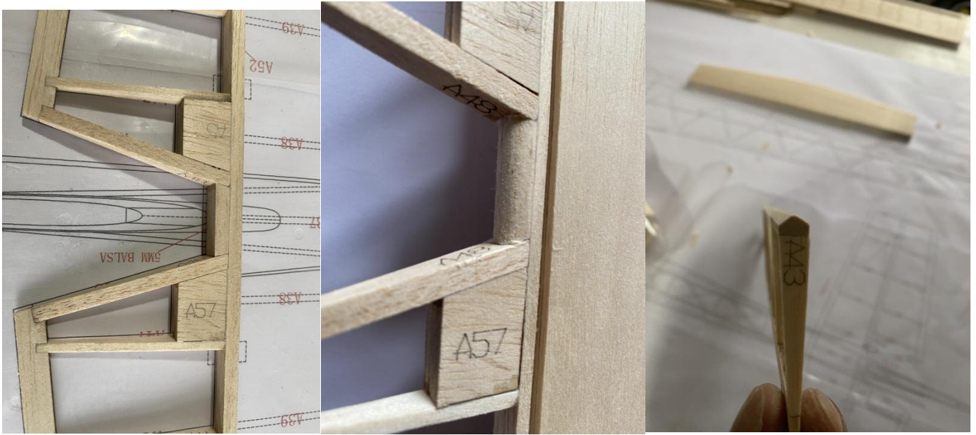
48-51: Zwei A22-Teile zusammenkleben, Seitenleitwerk nach Zeichnung aufbauen und Vorderkante profilförmig schleifen.
