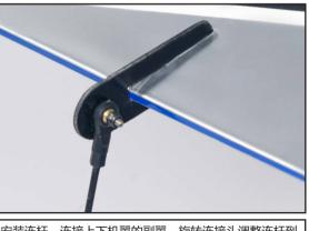
安装连杆,连接上下机翼的副翼。旋转连接头调整连杆到 合适长度。
