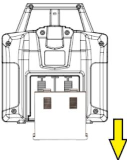
**Ziehen Sie die Abdeckung nach unten runter und setzen Sie die Batterien ein. [4x AA]**
