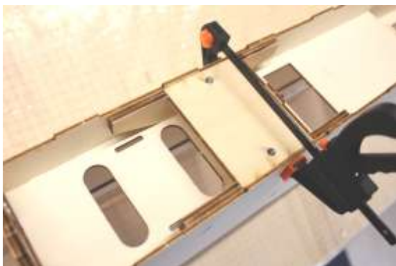
Fahrwerkshalter (J2) und Fahrwerksauflage (J5) im Rumpf verleimen
