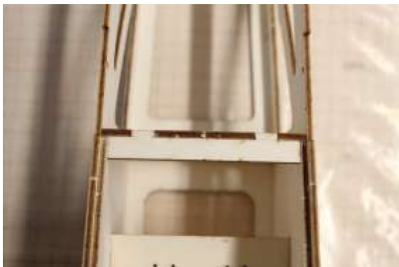
Steg (C4) an Spant (J3) einleimen.
