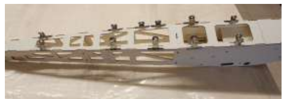
Hintere untere Rumpfbeplankung (F2) verleimen
