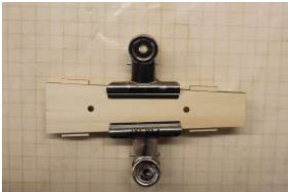
Leitwerkshalter (D4 und D5) für Höhenleitwerk verleimen
