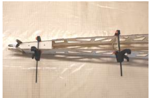
Rumpffenden zusammenziehen und Spant (F4), Lager für Seitenleitwerk (D3) und Leitwerkshalter für Höhenleitwerk (D4/D5) am Rumpfheck verleimen. Achtung auf Symmetrie achten
