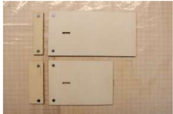
Haltemagneten (Ø6 mm) in Akkuraumdeckel (H4) und Gegenlager (B2), sowie in Gegenlager (C2) mit Sekundenkleber einkleben.
