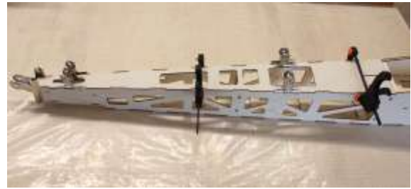
Hintere, obere Rumpfbeplankung (F1) verleimen
