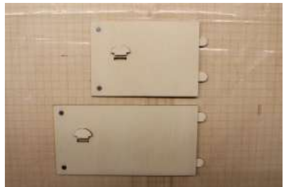
Je 2 Haltezungen (H1) an die Vorderseite von Akkuraumdeckel (H4) und Zugangsdeckel (H6) leimen Griff (H2) im Aufnahmeschlitz einpassen, aber erst nach dem Bespannen verleimen
