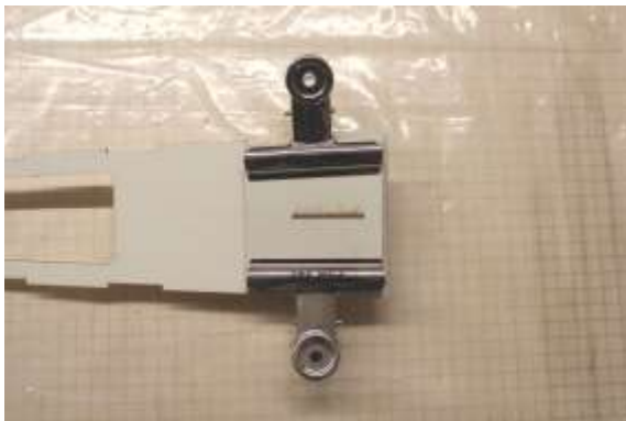
Träger für Schleppkupplung auf obere hintere Rumpfbeplankung (F1) verleimen
