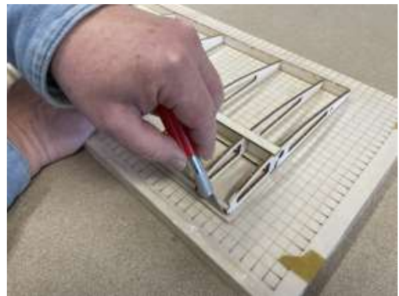
Tragfläche vorne bündig verschleifen.
