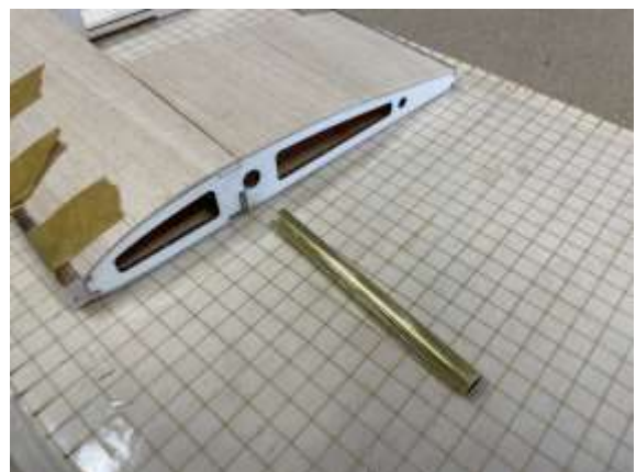
Messingrohr für die Flächensteckung einpassen.
