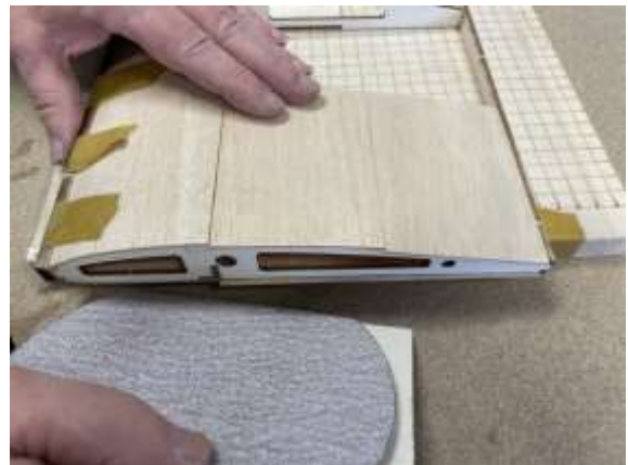
Messingrohr für die Flächensteckung einpassen.
