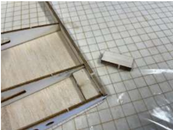
Füllstücke H3 wie gezeigt als Verstärkung einkleben.
