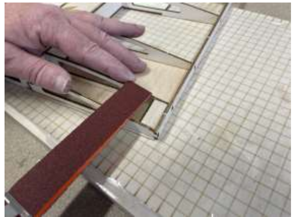
Jetzt die obere Beplankung aus 1.7mm Balsabrett aufkleben. Überstehende Beplankung bündig zu den Rippen verschleifen.
