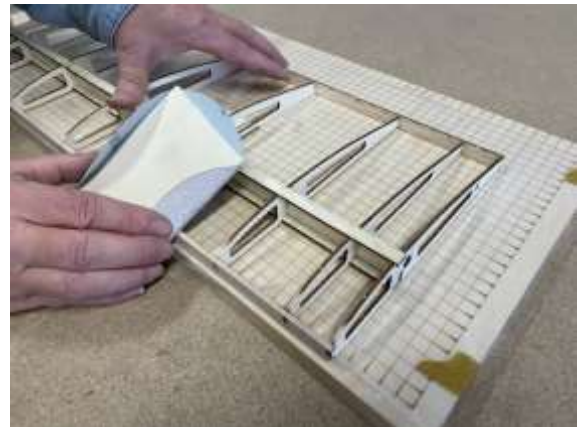
Leiste G1 / G2 passend zu den Rippen verschleifen.
