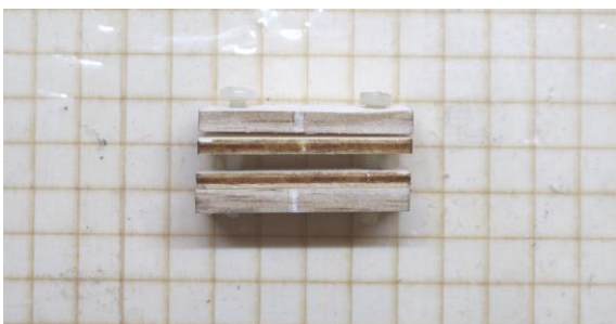
Vordere Tragflächenarretierung (A4) einleimen. Einbautipp: Tragfläche auf Rumpf auflegen und Arretierung einschieben. Die Nase der Arretierung muss dabei leicht in die Aufnahme in Spant (E4) hinein gleiten.
