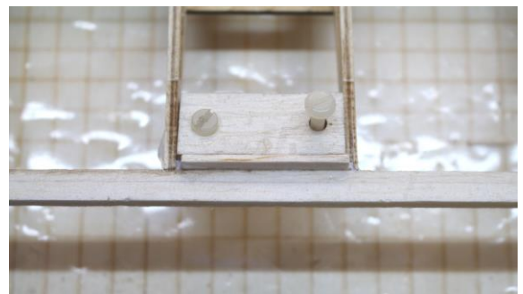
Spalt zwischen Block und Endleiste mit Restholz auffüttern.
