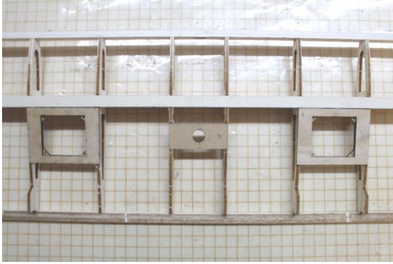
Servohalterahmen (J4/J1) und Kabeldurchführung (J6) auf Tragflächenunterseite einleimen.
