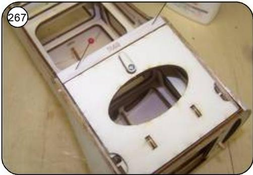
267 Deckel in den Rumpfboden einpassen und den Beplankungsstreifen R49 auf die Spanten aufkleben.
