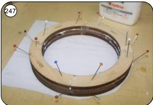
247 Bis zum Durchtrocknen mit Nadeln fixieren.
