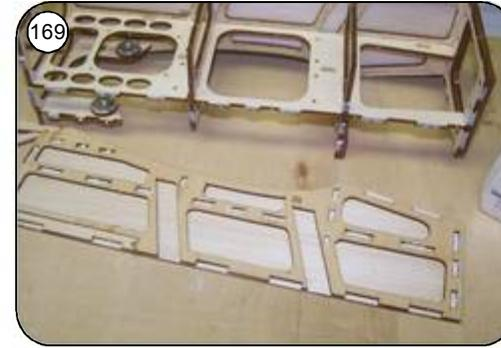
169 Gegenüberliegendes Rumpfseitenteil an den Klebestellen zum Spantengerüst mit Leim einstreichen und Spantengerüst einsetzen, wieder mit Gewichten belegen.
