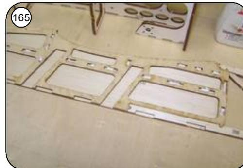
165 Steckungstaschen in R2 mit etwas Weissleim füllen und das Spantengerüst einsetzen, evtl. vorher ohne Kleber anpassen.
