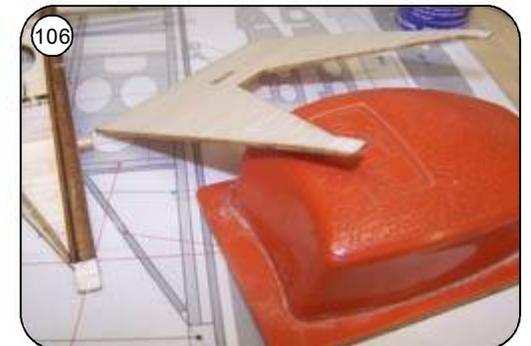
106 Obere Beplankung Mo13 an den Enden leicht schräg anschleifen ( Klebefläche ).
