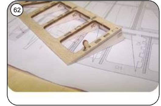
Verbindungszapfen für die Koppelgestänge der oberen und unteren Querruder probeweise einstecken.
