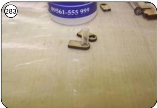
283 Bowdenzugabschnitt in Lager R48 einkleben, der Abstand ergibt sich durch die Aussparungen an der Rumpfunterseite, Bauteile in die Aussparungen an der Rumpfunterseite einkleben, Überstand des Bowdenzugabschnitts nach unten.
