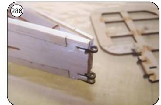
286 Oberes Lager R48 in dem Rumpfausschnitt ausrichten und einkleben.
