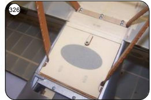
Zum Herstellen der Rudergestänge ein Stück Stahldraht an einem Ende auf eine Länge von 2 mm um 90° abwinkeln, das kleine, ovale Holzsegment aufstecken und evtl. mit etwas Sekundenkleber sichern. Gestänge auf passende Länge kürzen, am anderen Ende ein Z-Gestänge biegen und in den Servohebel einhängen, Schrumpfschlauch aufschieben und mit Ruderhorn einschrumpfen.
