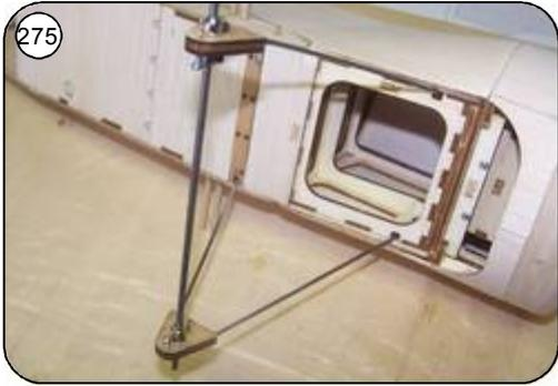
275 Fahrwerk am Rumpf montieren, vordere Fahrwerksdrähte mit 2K-Kleber in die Federungskulissen einkleben.
