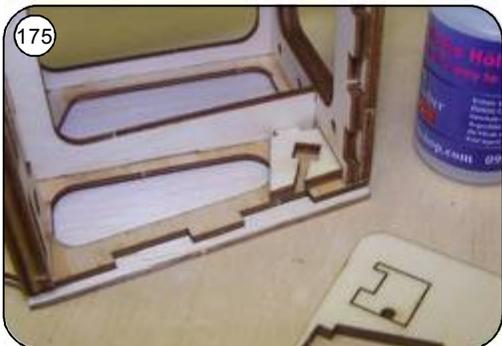
175 Teile gemäß der in den Fotos dargestellten Reihenfolge mit dünnem Sekundenkleber rechts und links in die Seitewände einkleben.
