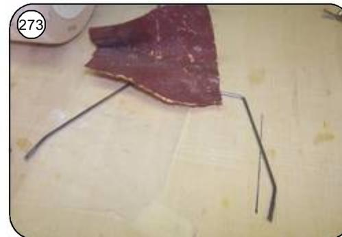
273 Hinteren Fahrwerksdraht an allen Klebeflächen mit Schleifpapier anschleifen.
