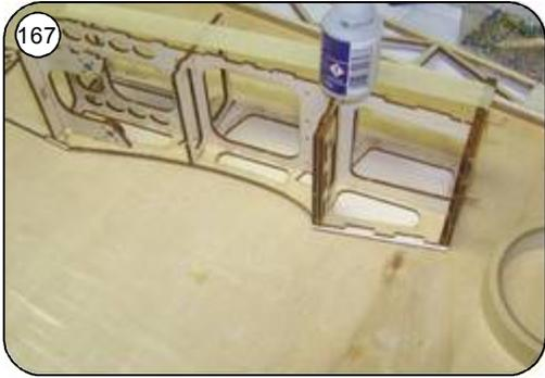
167 Die offene Seite des Spantengerüsts mit einem Tesakreppstreifen zusammenspannen und mit Sekundenkleber an allen Stoßstellen verkleben. Bis zum Durchtrocknen mit Gewichten belegen.
