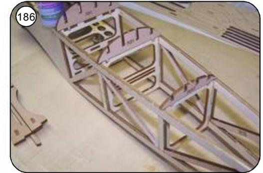
183 Den Rumpf im vorderen Bereich mit Gewicht belegen ( plan auf dem Baubrett ) dann die Stützen St1 bis St4 im hinteren Bereich gem. Plan unterbauen und das Rumpheck zusammen ziehen, Gewicht auf der Oberseite. Verklebung mit dünnem Sekundenkleber.
