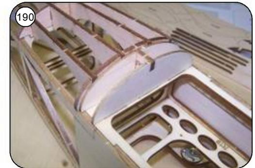
187 Rumpfrückenleisten R34 und R35 vorsichtig in die Halbspanen einsetzen und mit diesen verkleben. Abschluss R33 einschieben und mittig auf dem Rumpf ausrichten. Mit Sekundenkleber verkleben.
