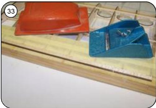
33 Endleiste an der Endkante nach Plan verschleifen. Doppelt geklebte Kreppstreifen auf die Rippenenden geklebt verhindern versehentliches anschleifen dieser.
