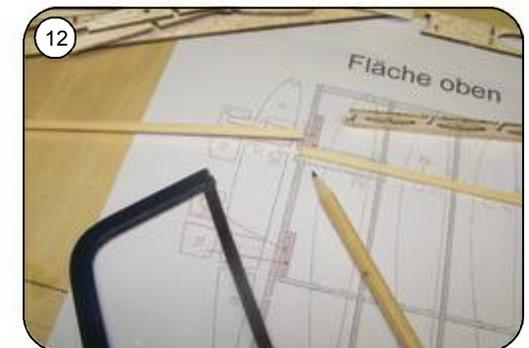
Unteren Holmgurt Kiefer 2x4 mm nach Plan ablängen. Ein Millimeter Übermaß kann nicht schaden.
