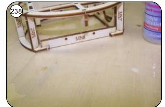
238 Befestigungssteg Mh8 in den Ringspant Mh5 einkleben.
