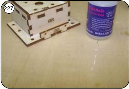
227 Verschraubungssteg für die Motorhaube Mt5 in die entsprechenden Aussparungen einkleben.
