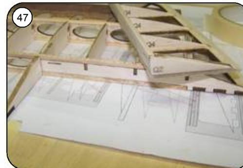
47 Scharnierkante für die gewünschte Scharnierausführung verschleifen, Schnitte s. Plan.
