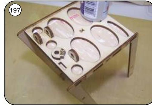
Halteösen B5 für die Steckungsdübel auf der Oberseite von B4 einkleben.
