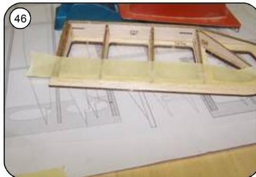
46 Endleiste wie bei der Tragfläche nach Plan verschleifen.
