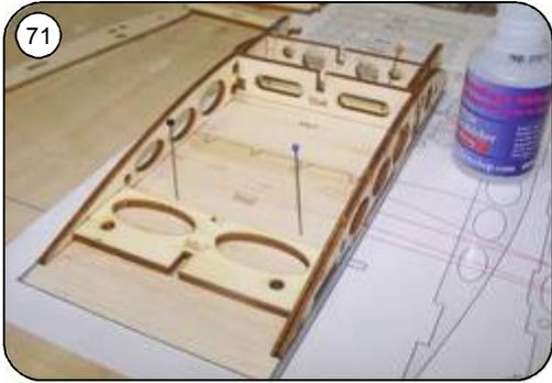
Baugruppe Mu3 - Mu6 ( Rippengerüst ) zusammen mit der Verschraubungsauflage Mu7 auf die Beplankung Mu1 / Mu2 aufkleben.
