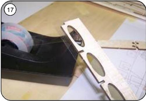
17 Endleiste F4 an der Unterseite mit Tesafilm abkleben ( Rippentaschen ).
