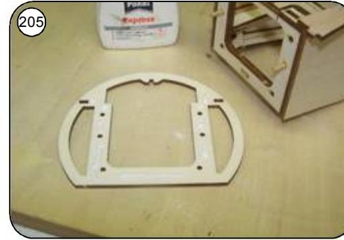
205 Vorderen Ringspant R43 an den Rumpfkopf kleben und mit Klammern bis zum Durchtrocknen sichern.
