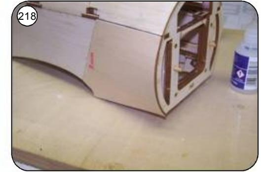
218 An der Endkante mit dickem Sekundenkleber, den Rest von der Innenseite mit dünnem Sekundenkleber verkleben.
