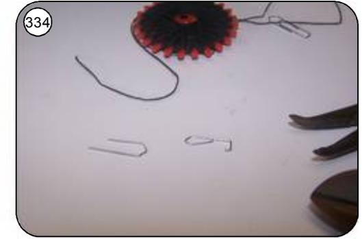
334 Häkchen aus Büroklammern gebogen ermöglichen eine evtl. Demontage der Verspannungen.
