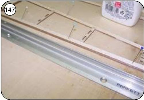
147 Rumpfinnengurt R4 und Rumpfabschluss R5 aufkleben und bis zum Durchtrocknen mit Nadeln auf dem Baubrett fixieren
