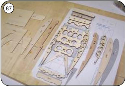
87 Bauteile für das obere Flächenmittelstück aus den Laserbrettern auslösen und vorsortieren.
