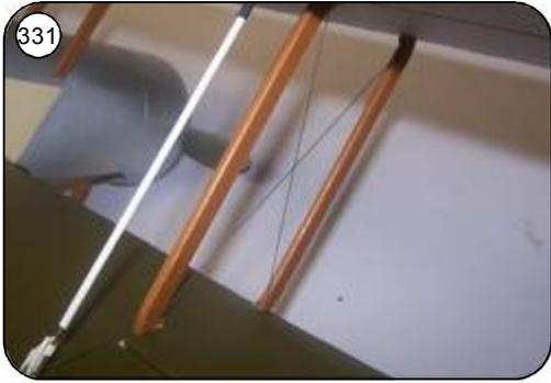
331 Koppelgestänge für die Querruder auf passende Länge zuschneiden. Verbindung zum Ruderhorn mit Schrumpfschlauch. Alternativ kann zur einfacheren Demontage an einer Gestängeseite ein Sicherungsclip verwendet werden.
