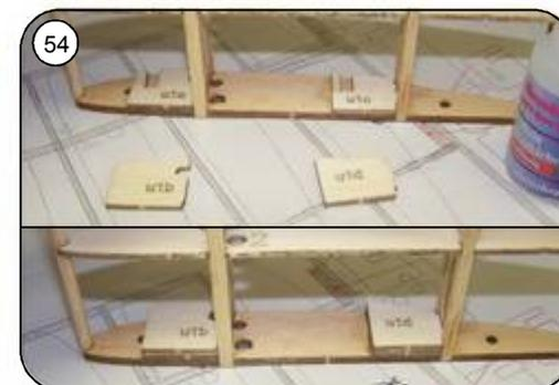
Auflagen für Servohalterung 9a und 10a auf die entsprechenden Rippen 9 und 10 nach Plan aufkleben, Rippen in die Fläche einsetzen. Taschen für die Verspannungsösen u1a bis u1d auf Rippe 1 nach Plan aufkleben.
