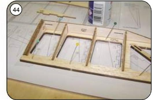
44 Aufdoppelung der Scharnierleiste Q7 auf die Rippenzapfen aufschieben und verkleben. Rippe Q6 einkleben.
