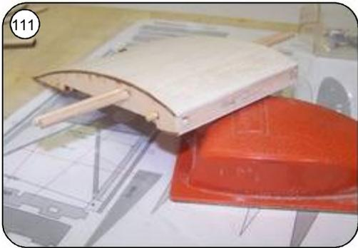
111 Beplankungsüberstände rundum bündig verschleifen.
