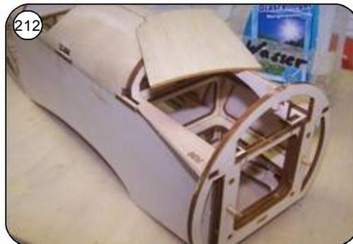
212 Vordere Beplankung R46 ebenfalls von aussen mit Wasser anfeuchten und vorbiegen. Beplankung aufsetzen und von der Innenseite mit Sekundenleber verkleben.
