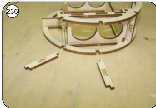
236 Verbindungsstege Mh7 für die Ringspanten rundum einsetzen und verkleben.
