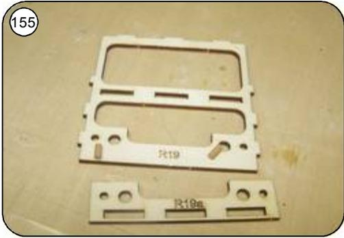
155 Bauteile für den Rumpfaufbau vorbereiten, dazu Hilfsspant R19a mit Buchendübeln 3 mm auf Spant R19 aufkleben und verpressen.
