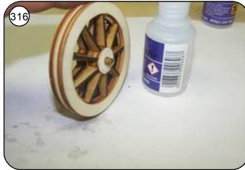
Radachse ( MS-Rohr 4/3 x 14 mm ) einkleben.
