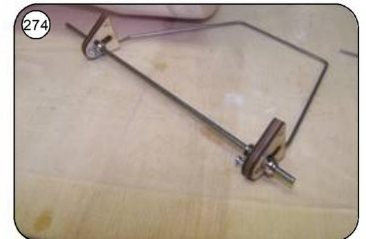
274 Federungskulissen mit 3 mm Stelling auf der Hauptachse ausrichten und fixieren Fahrwerksdraht mit 2K-Kleber einkleben.
