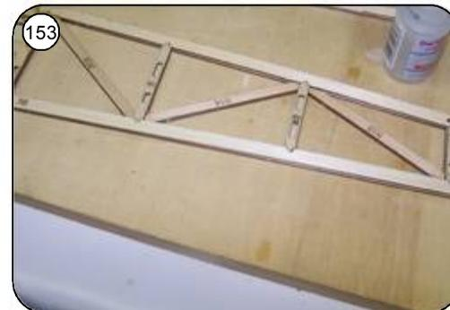
152 Die Diagonalstege R13, R14 und R15 von der Rumpfinnenseite einsetzen und dabei mit der Rumpfaussenseite bündig durchdrücken, mit dünnem Sekundenkleber einkleben.
