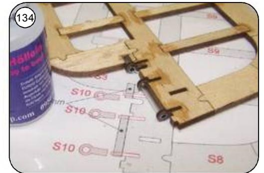
134 Unteres Scharnierlager ( Röhrchen + 2x S10 ) in das Seitenruder einkleben. ( Ruderhorn S11 nach dem Bespannen )
