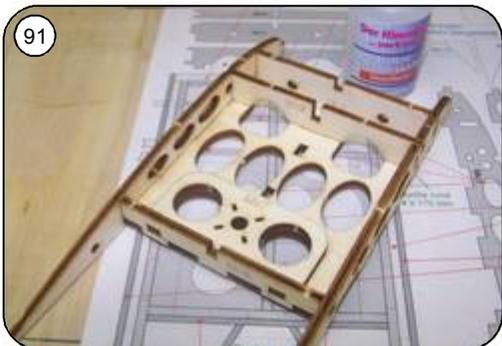
91 Aufdoppelung Mo7 einsetzen und mit Sekundenkleber verkleben.
