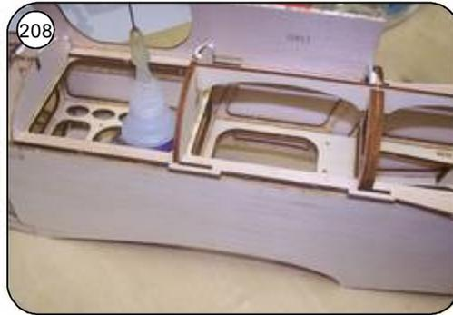
208 R45 auf dem Rumpfteil aufsetzen und mit Sekunde von der Innenseite verkleben, Spanten mit Weissleim einstr.
