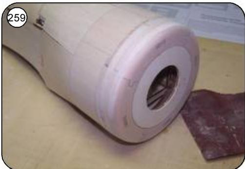
259 Die Form der Motorhaube kann jetzt passend zum Rumpfkopf verschliffen werden.
