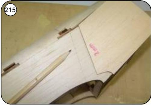
215 Beplankung R47 ( Übergang Rumpf - Ringspant ) anlegen und die Endkante am Rumpf anzeichnen. Endkante der Beplankung als Auflage am Rumpf schräg anschleifen.
