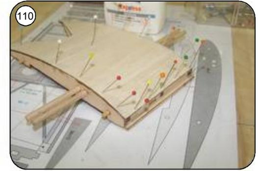
110 Obere Beplankung Mo14 mit Weissleim auf das Mittelstück aufkleben und bis zum Durchtrocknen mit Nadeln sichern.
