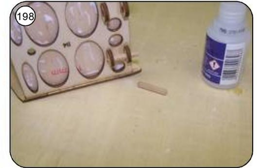
Buchendübel 4mm nach Plan ablängen und mit Sekundenkleber in die Halteösen B5 einkleben.
