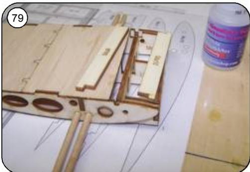
Verstärkungsstege Mu9 und Mu10 von der Unterseite einkleben ( Fahrwerkstasche ).
