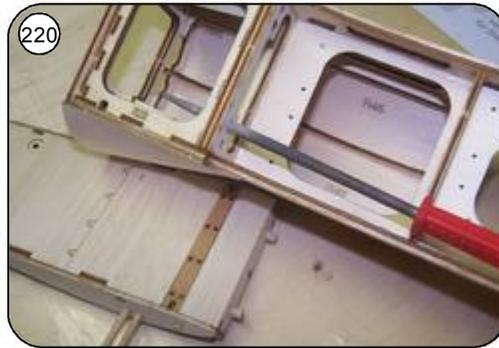
220 Unteres Flächenmittelstück in den Rumpf einpassen, Bohrungen für die Steckdübel evtl. noch etwas ausreihen. Mittelstück einsetzen und die untere Beplankung für den Übergang Endleiste / Rumpf passend dazu einkleben.
