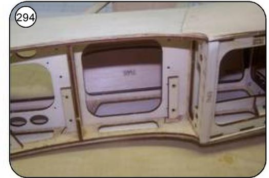
Aufdoppelungen und Streben im später sichtbaren Bereich verrunden und sauber verschleifen. Baldachin nochmals in das Flächen mittelstück einpassen, auf Leichtgängigkeit achten. Kunststoffschraube M4 passend ablängen.
