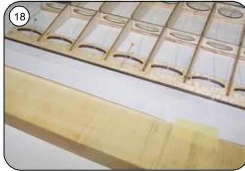
18 Endleiste F4 einschieben, mit Nadeln sichern und mit den Rippen verkleben
