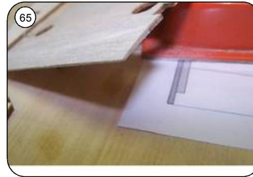
Endkante von Mu2 schräg anschleifen - Klebfläche.
