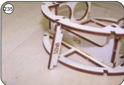
235 Verbindungssteg Mh6 für die Ringspanten oben in das Haubengerüst einkleben. Doppelkerbung in Richtung Mh5 !!!
