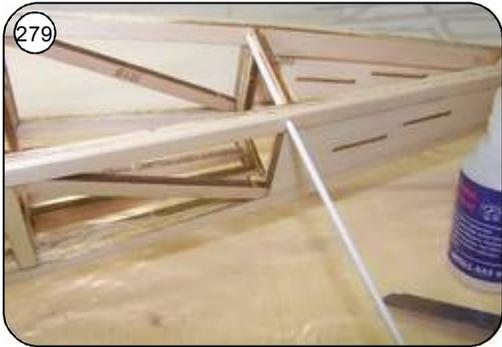
279 Vorderes und hinteres Steckungsröhrchen ( Bowdenzug 2mm ) für die Leitwerksabstrebung in die entsprechenden Bohrungen im Rumpf einkleben und mit der Rumpfaussenseite bündig abschneiden.
