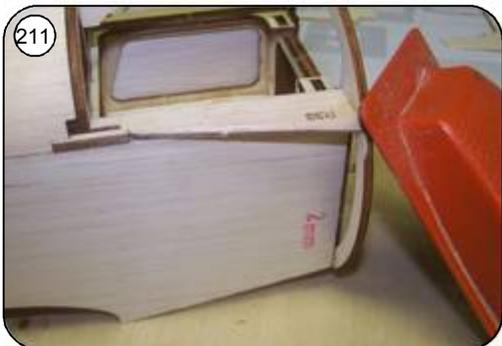
211 Beplankungsauflege R39 entsprechend der Rundung des Ringspantes schräg anschleifen.
