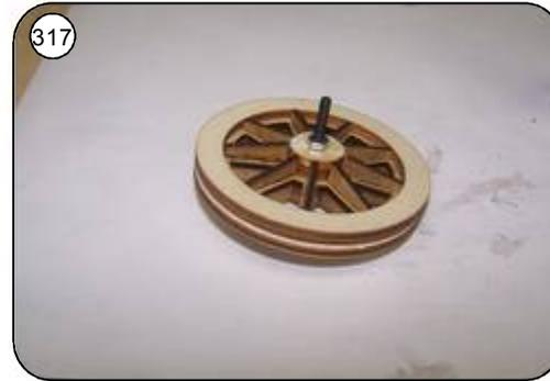
Längere M4 Gewindeschraube in der Radachse verschrauben. Das Rad mit der Schraube in eine Bohrmaschine einspannen und bei niedriger Drehzahl mit einer Rundfeile das Felgenbett ausreiben / drechseln.
