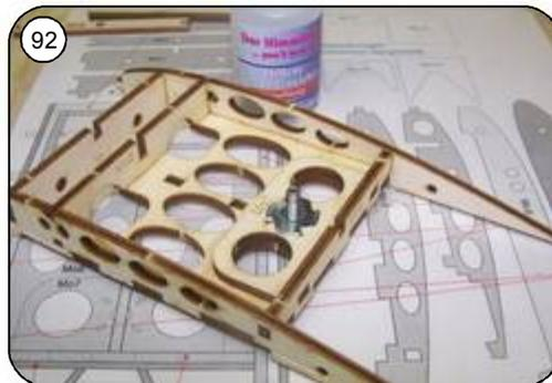
92 Einschlagmutter M4 mit entspr. Schraube einziehen und mit Sekundenkleber sichern.
