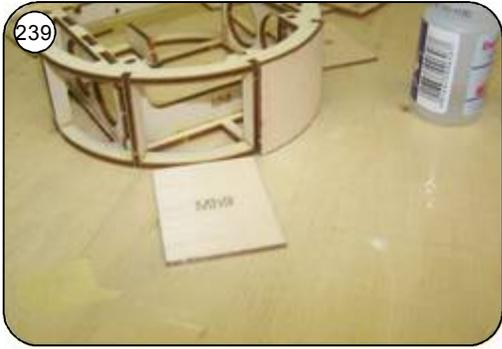
239 Beplankungsteile Mh9 von oben anfangend rechts und links je 2 Stck. aufkleben. Verklebung von der Innenseite mit dünnem Sekundenkleber.
