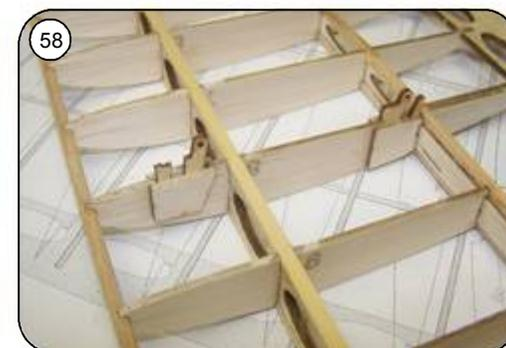
Teile für Servohalterung aus dem Laserbrett auslösen und Servohalterung zusammenkleben, probeweise in die Fläche einsetzen.
