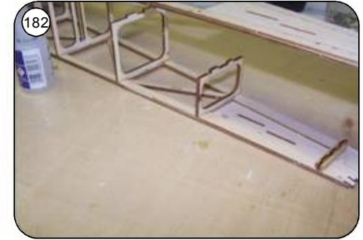
182 Spanten R27 bis R30 in das Rumpfseitenteil einstecken und mit einem Tröpfchen Sekundenkleber anheften.
