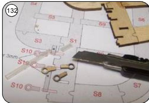
132 Bowdenzugröhrchen 3mm für das SR-Scharnier nach Bauplan zuschneiden.
