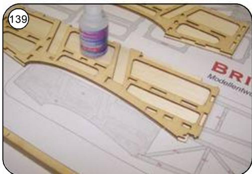
139 Von der Innenseite mit dünnem Sekundenkleber nachkleben ( unter das Sperrholz einkriechen lassen ).
