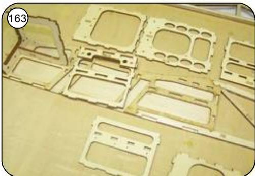
163 Spantengerüst aus den Teilen R16/17, R18, R19/19a und R20 bis R24 zusammensetzen und rechtwinklig zueinander ausrichten, evtl. mit wenig Sekundenkleber heften.
