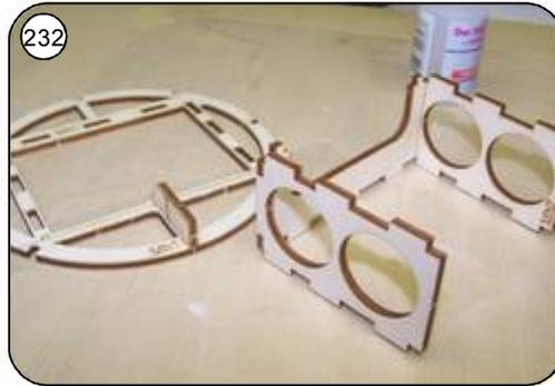
232 Distanzgerüst aus Mh2 und Mh3 zusammenkleben, in den vorderen Ringspant Mh1 einstecken und mit Sekundenkleber verkleben.
