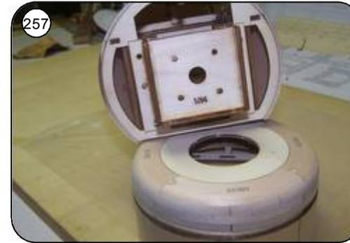
257 Den fertigen Motorträger vorläufig mit 2 Schrauben am Rumpfkopf befestigen, die Motorhaube aufsetzen und von der Unterseite mit dem Motorträger verschrauben.
