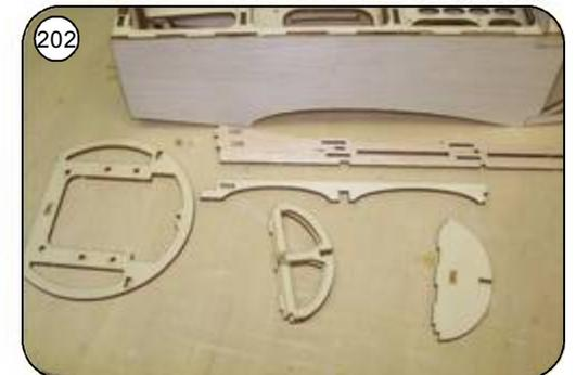
Teile für die Rumpfrückenbeplankung R39 bis R43 selektieren.
