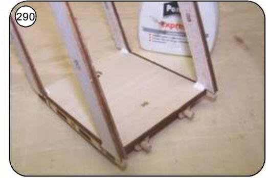
Aufdoppelungen für die Baldachinstreben B7 bis B10 auf die Innen- und Aussenseite der Streben aufkleben. Den Übergang zwischen Aufdoppelung und Beplankung vermuffen.
