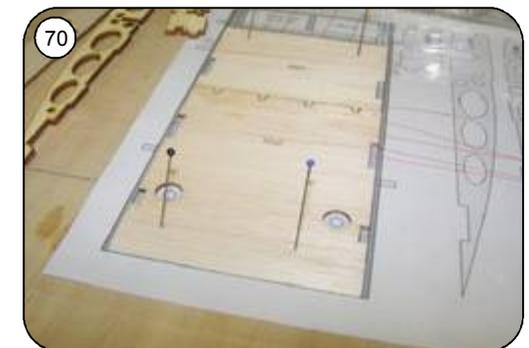
Untere Beplankung Mu1 / Mu2 auf den Bauplan aufnadeln.
