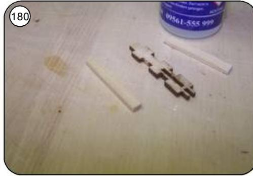
180 Spant R30 beidseitig mit Reststücken Kiefer 4x2mm aufdoppeln und danach den Steg am unteren Ende mit 2mm ausbohren ( Spornsteckung )
