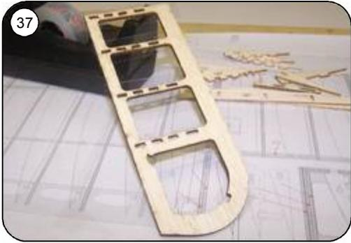
37 Steckungsslitze von Querruderboden Q1o an der Unterseite mit Tesafilm abkleben.
