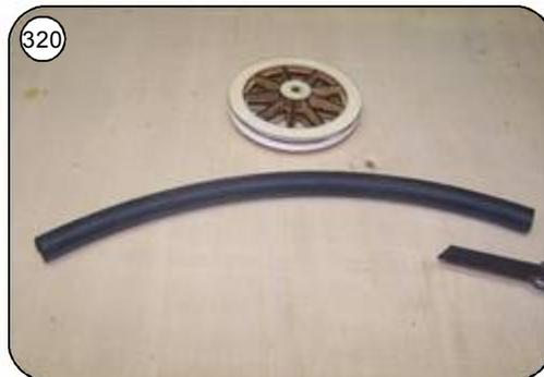
Moosgummischnur auf 210 mm mit einem Cuttermesser ablängen, anfeuchten der Cutterklinge erleichtert das Schneiden.
