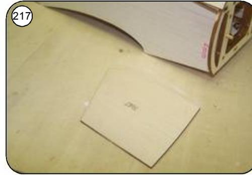
217 An der Endkante mit dickem Sekundenkleber, den Rest von der Innenseite mit dünnem Sekundenkleber verkleben.
