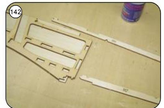
142 R6 und R7 an den Zapfen von R2 ausrichten und ankleben.
