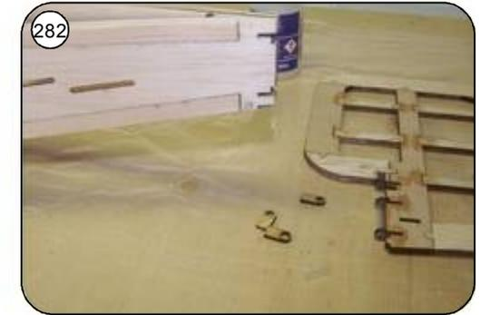
282 Scharnierlager R48 selektieren und Bowdenzugrohr 3mm etwa auf 8 mm Länge ablängen.
