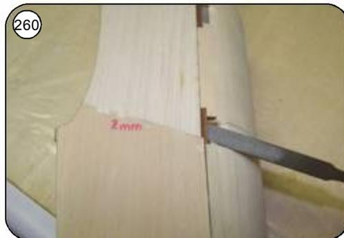
260 Taschen für die Baldachinstreben mit einer flachen Schlüsselfeile ausfeilen und den Baldachin leichtgängig einfügen.
