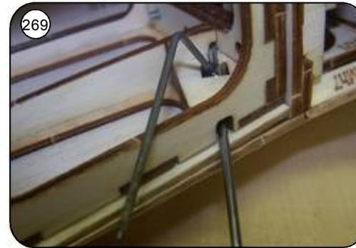
269 Vordere Fahrwerksdrähte in die Aufnahmen im Rumpf einstecken und mit 2mm Stelling sichern.
