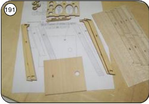
Als Zwischenschritt wird jetzt der Baldachin für die obere Tragfläche gebaut, in diesem Baustadium des Rumpfes geht das noch am einfachsten. Die Streben B1 und B2 in die Taschen der Rumpfs Seitenteile einstecken und B4 dazwischen einheften.
