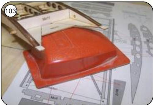
103 Enden von Beplankung Mo10 leicht schräg anschleifen ( Klebefläche ).
