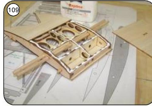
109 Obere Beplankung Mo14 mit Weissleim auf das Mittelstück aufkleben und bis zum Durchtrocknen mit Nadeln sichern.
