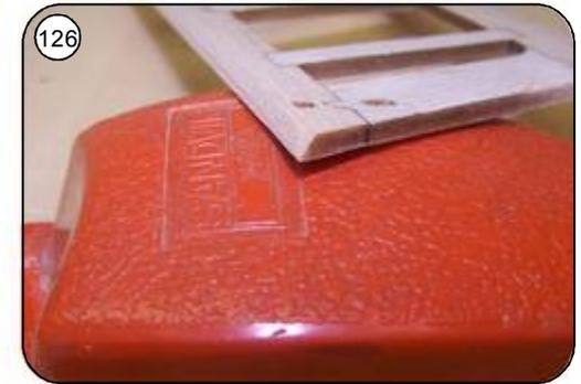
126 Scharnierkante zur Unterseite hin schräg anschleifen, Aussenkanten verrunden.
