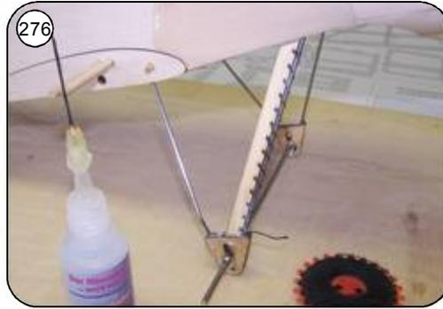
276 Fahrwerksverkleidungen mit Haushaltszwirn an den Fahrwerksdrähten annähen und mit dünnem Sekundenkleber verkleben. Fahrwerksverkleidungen an die Federungskulissen mit 2K-Kleber ankleben.
