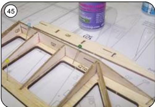
45 Scharnierleiste Q8 aufstecken und mit Sekundenkleber ankleben.
