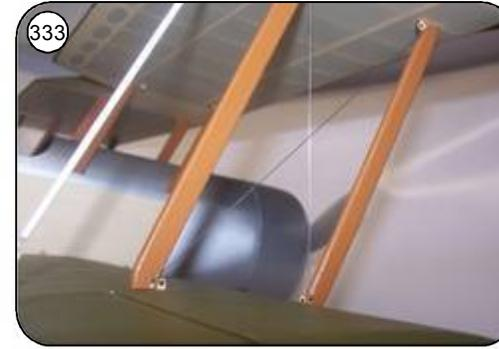
333 Streben einbauen und mit entsprechend langen 0,8 mm Stahldrähten gegeneinander verspannen, mit Epoxy verkleben.
