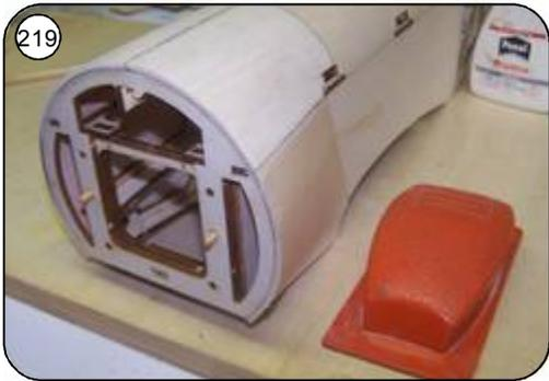
219 Beplankungsüberstände am Rumpfkopf bündig verschleifen.
