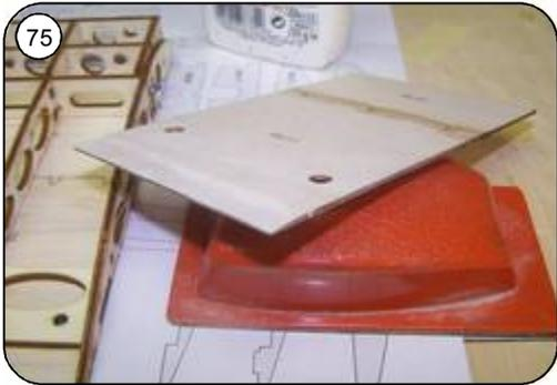
Endkante von Mu13 schräg anschleifen ( Klebekante ), Beplankung mit Weissleim auf das Rippengerüst aufkleben und mit Nadeln sichern.
