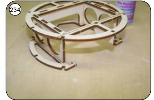
234 Fertige Baugruppe in den hinteren Ringspant Mh5 einstecken und ebenfalls mit Sekundenkleber verkleben.
