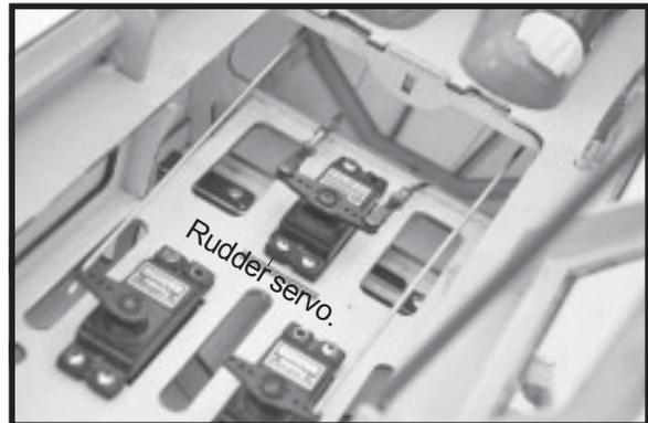
**RUDDER CONTROL HORN INSTALLATION.**
