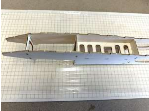
Rumpf umdrehen und Spant F7 einsetzen.
